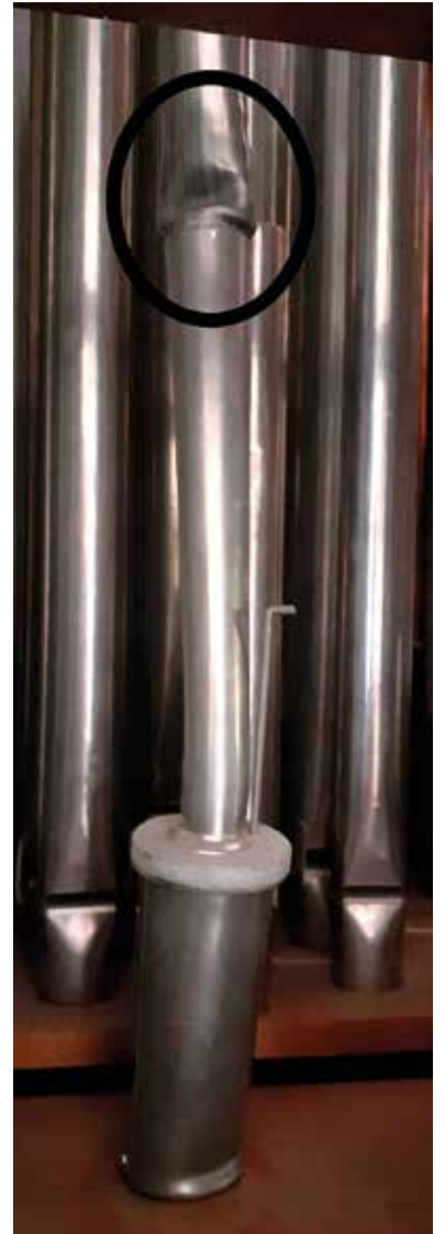
Trumpetti-äänikerran pilli on lommahdannut mutkalle.
