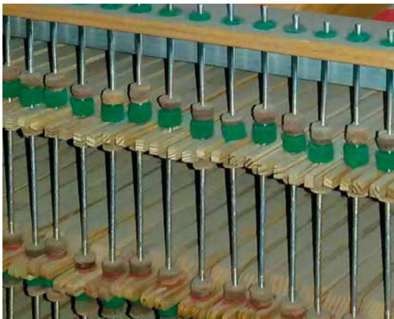
Vetolankojen ja koskettimiston liitos urkujen sisällä.
